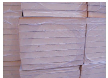
Neue Dämmmaterialien nach 2015 aus EPS enthalten kein HBCD mehr
